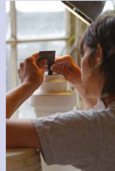
Tournassage d'une céramique dans le grand atelier de la manufacture de Sèvres.
